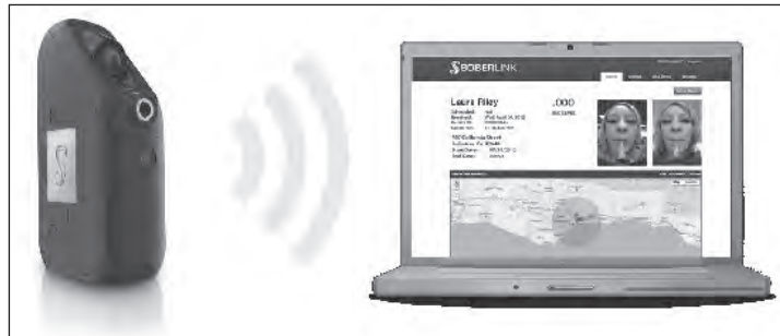
図1 飲酒検知用の高機能呼気測定器の仕組み
